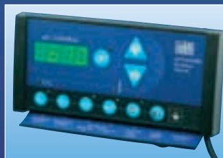
Dennerle pH-Controller Evolution DeLuxe непрерывно измеряет значение pH и автоматически регулирует с помощью электромагнитного клапана подачу CO 2 в аквариум.
